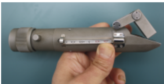
Εικόνα 5: Φορητό διαθλασίμετρο για προσδιορισμό στον οπωρώνα της συγκέντρωσης διαλυτών στερεών συστατικών σε χυμό μήλων. (Εργαστήριο Μετασυλλεκτικής Τεχνολογίας, ΙΓΕ)
