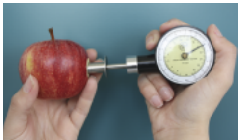
Εικόνα 3: Μέτρηση συνεκτικότητας μήλου με πιεσόμετρο τύπου Effegi. (Εργαστήριο Μετασυλλεκτικής Τεχνολογίας, ΙΓΕ)
