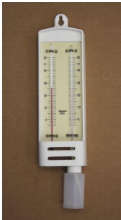
Εικόνα 7: Θερμόμετρο ξηρού και υγρού βολβού για προσδιορισμό της σχετικής υγρασίας σε ψυκτικούς θαλάμους διατήρησης μήλων. (Εργαστήριο Μετασυλλεκτικής Τεχνολογίας, ΙΓΕ)
